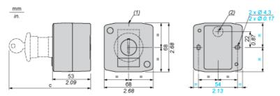
(1) 2 prerrecortes para prensaestopas Pg 13.5, capacidad máxima 12 mm (0.47 in)
