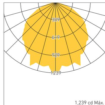
5.1 EFICIENCIA DEL SISTEMA 133 lm/W @3,000K
